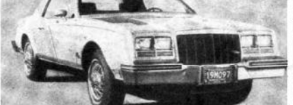
۸- «پونتیاک فیربرده شکاری و کوپه که جلوی آن از مواد پلاستیک مصنوعی ساخته شده است و وزنش صد کیلو از مدل‌های گذشته سبک‌تر است.
