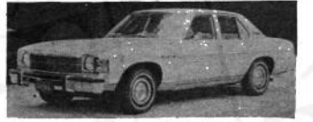
بایوک «لوساپراکتوم» ۸ سیلندر است ۱۵۷ اسب بخار قدرت و ۱۷۰ کیلومتر در ساعت سرعت دارد این اتومبیل نیز در هر صد کیلومتر ۲۱ لیتر بنزین مصرف می کند قیمت آن ۵۱۱۲ دلار است.
