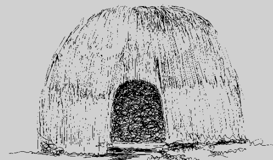
نوع مسکن روستائی خاص منطقه جبرفت مصالح ساختمانی- از نوع گیاهی بناه کل Col که دریا تالابهای هلیل رود میزباید پی و سقف هر دو از کل Col است
